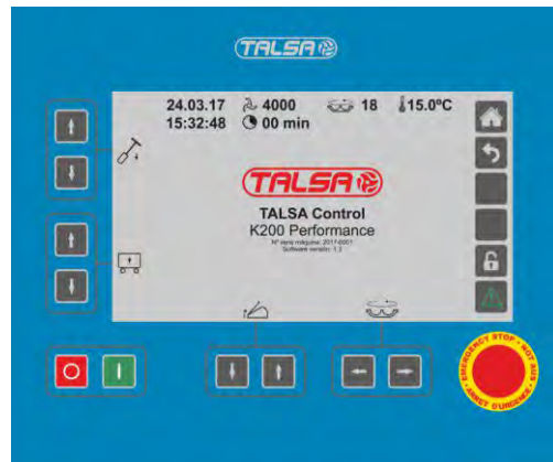
Bedienfeld mit großem 10" Touchscreen und Folientastatur zur Kontrolle aller wichtigen Funktionen.
