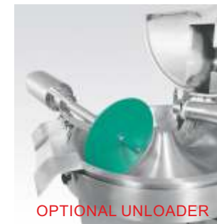
Optional: Motorized unloader. Auf Wunsch: Motorisierter Auswerfer. Option: Bras déchargeur motorisé. Optie: Gemotoriseerde uitlaadam. Opzione: Motordrevet udkaster. Opzione: Braccio scarica motorizzato. Opción: Brazo descarga motorizado.
