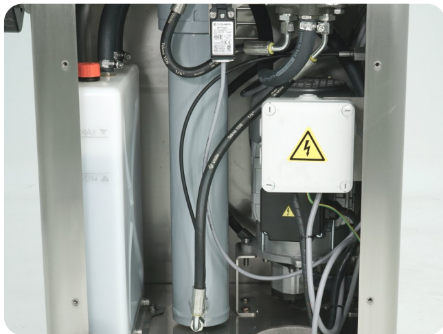
Groupe hydraulique puissant. Réservoir d'huile transparent indépendant.
