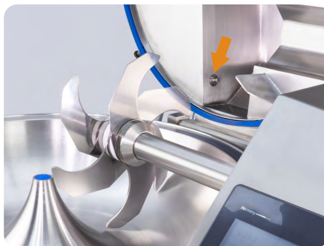
Capteur de température situé dans la cavité de coupe, endroit où la température est maximale.
