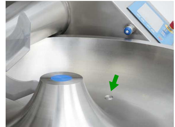
Ablafschraube am Schüsselboden erleichtert die Reinigung.
