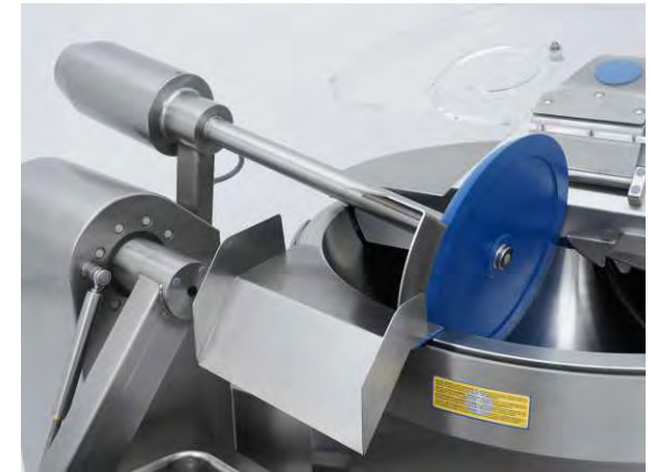
Hydraulischer Brätauswerfer mit motorisierter Auswerferscheibe, vereinfacht das Entladen.
