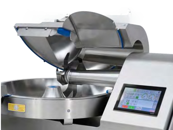
Motorisierte Messerabdeckung aus rostfreiem Edelstahl.
