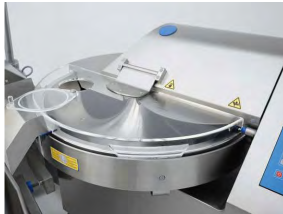
Transparenter Lärmschutzdeckel, mit Dosieröffnung und automatischer Reduzierung der Messergeschwindigkeit beim Öffnen.
