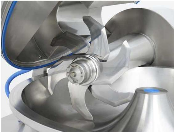
Cabezal de cuchillas con **6 cuchillas estándar** de BE-Maschinenmesser Alemania.
